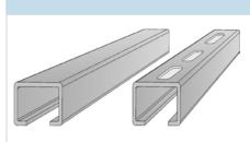
Montageschienen kaltgewalzt, geeignet zum Anschweißen und Andübeln. Ausführungen: Stahl walzblank, Stahl feuerverzinkt und sendzimirverzinkt, Edelstahl 1.4401/1.4571 (A4), Edelstahl 1.4301 (A2)
